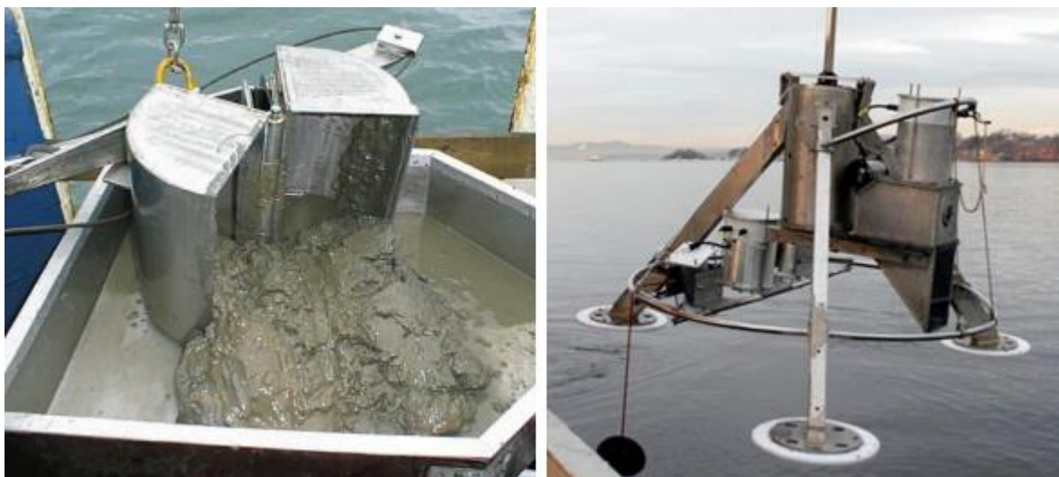
Figur 35. Van Veen-grabb (venstre) som benyttes til prøvetaking av bløtbunnsfauna og SPI-kamera (høyre) som tar et horisontalt bilde av sedimentet. Foto: NIVA
